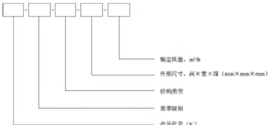
**示例 1:** 中效 2 型、袋式、外形尺寸为 592 mm×592 mm×600 mm、额定风量为 3 400 m<sup>3</sup>/h 的空气过滤器, 标记为 K-Z2-DG-592×592×600-3400。
