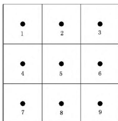
图 A.4 测量风速和气溶胶浓度均匀性的 9 点均匀分布网格示意图
